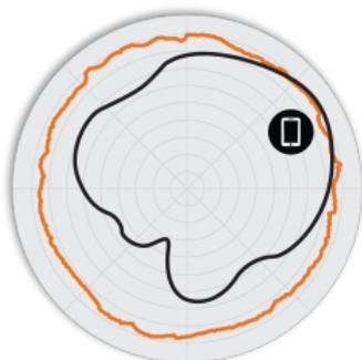
Figura 3. Pattern di antenna Azimut a 5 GHz per T710o
