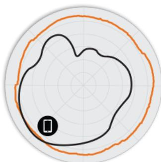
Figura 4. Pattern di antenna Elevazione a 2,4 GHz per T710o
