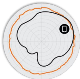
Abbildung 3. T710o 5 GHz-Azimet-Antennenmuster
