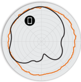
그림 2 T610o 2.4GHz 방위각 안테나 패턴
