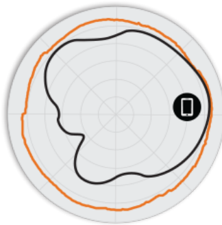
그림 3 T610o 5GHz 방위각 안테나 패턴
