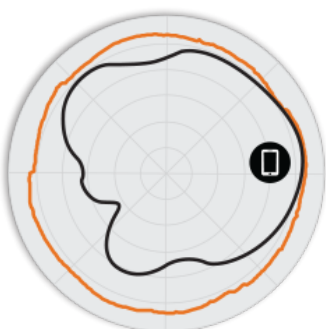
FIGURE 3 Diagrammes d'antennes Azimut T610o 5 GHz
