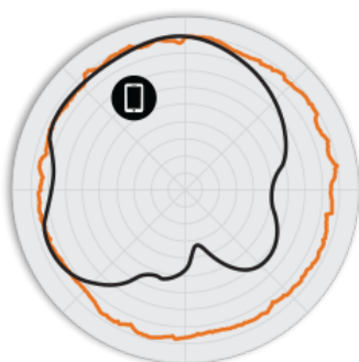
FIGURE 2 Diagrammes d'antennes Azimut T610o 2,4 GHz
