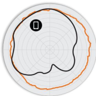
FIGURA 3 T610o 5 GHz: patrones de antena en acimut
