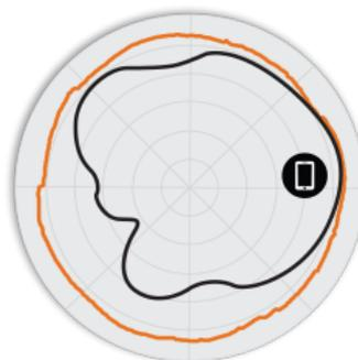
FIGURA 4 T610o 2,4 GHz: patrones de antena en elevación
