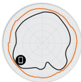
Figura 2. Pattern di antenna Azimut a 2,4 GHz per T310d
