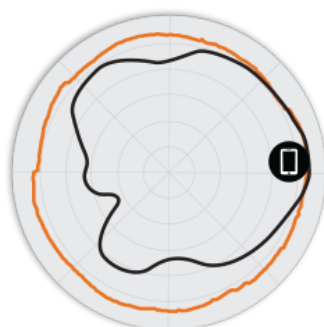
Figura 3. Pattern di antenna Azimut a 5 GHz per T310d
