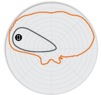
図 5. R750 5GHz エレベーション アンテナパターン
