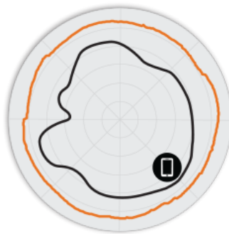
FIGURA 3 R750 5 GHz: patrones de antena en acimut
