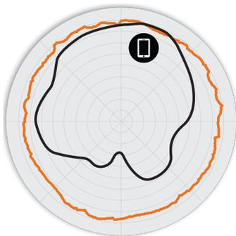
Figura 3. Pattern di antenna Azimut a 5GHz per R730
