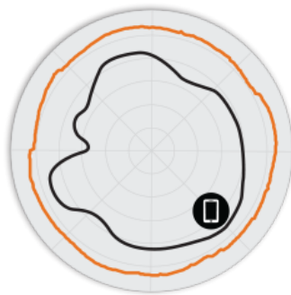
圖 3 R720 5GHz 方位角天線模式
