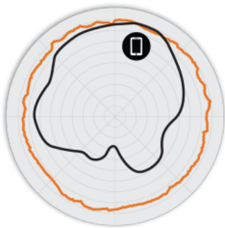
圖 2 R720 2.4GHz 方位角天線模式
