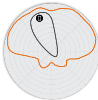
그림 4 R720 2.4GHz 고도 안테나 패턴
