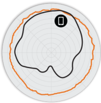
그림 2 R720 2.4GHz 방위각 안테나 패턴
