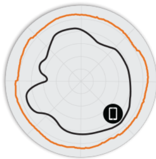
그림 3 R720 5GHz 방위각 안테나 패턴
