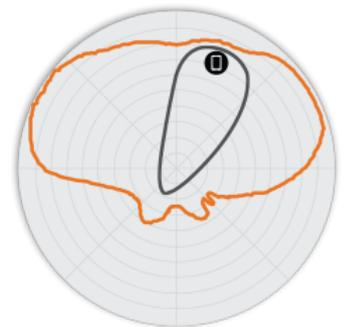
附註：外圈軌跡代表所有可能的 BeamFlex+ 天線模式匯集而成的複合 RF 覆蓋區域，內圈軌跡則代表這個複合外圈軌跡內的其中一個 BeamFlex+ 天線模式。
