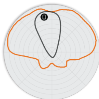
FIGURA 4 Padrões de antena de elevação R710 2,4 GHz
