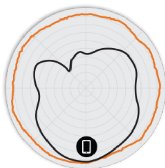
FIGURA 2 Padrões de antena do azimute R710 2,4 GHz
