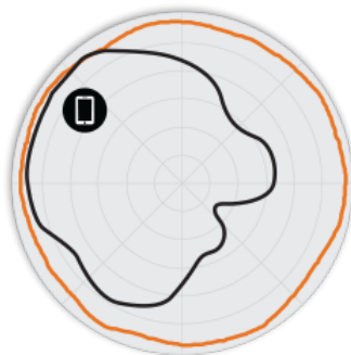
그림 3 R710 5GHz 방위각 안테나 패턴
