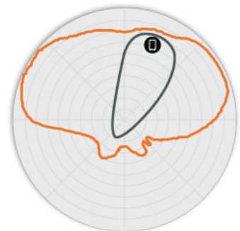
그림 5 R710 5GHz 고도 안테나 패턴
