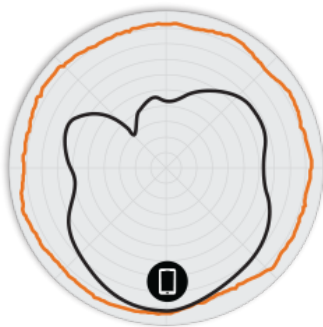
그림 2 R710 2.4GHz 방위각 안테나 패턴
