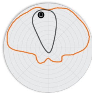
그림 4 R710 2.4GHz 고도 안테나 패턴
