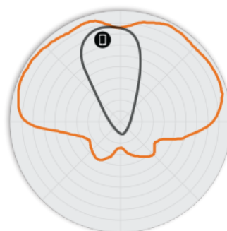
Figura 4. Pattern di antenna Elevazione a 2,4 GHz per R710
