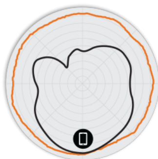
Figura 2. Pattern di antenna Azimut a 2,4 GHz per R710
