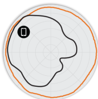
Figura 3. Pattern di antenna Azimut a 5 GHz per R710
