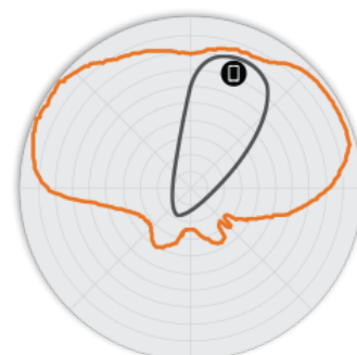
Figura 5. Pattern di antenna Elevazione a 5 GHz per R710
