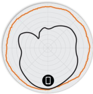
FIGURE 3 Diagrammes d'antennes Azimut R710 5 GHz
