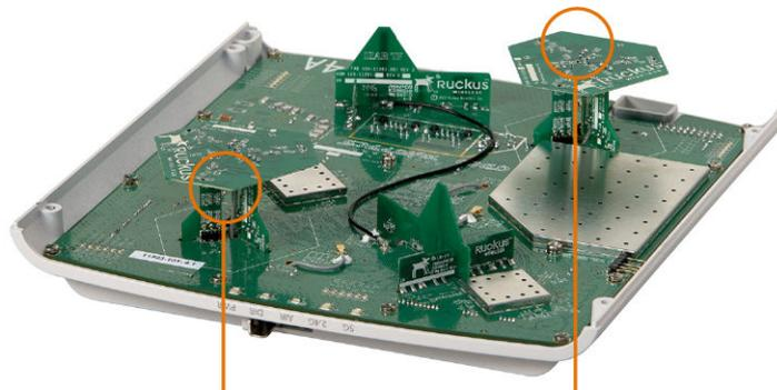
Technologie d'antennes adaptatives BeamFlex+
