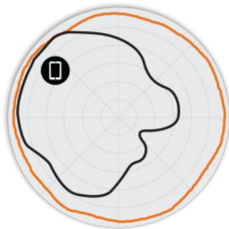
FIGURE 4 Diagrammes d'antennes Élévation R710 2,4 GHz
