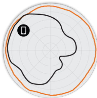
FIGURA 3 R710 5 GHz: patrones de antena en acimut
