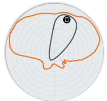
FIGURA 5 R710 5 GHz: patrones de antena en elevación
