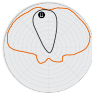
FIGURA 4 R710 2,4 GHz: patrones de antena en elevación
