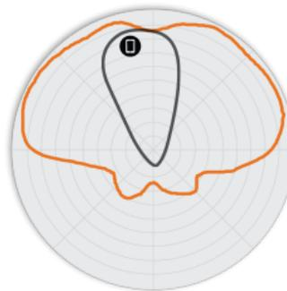
Abbildung 5. R710 5 GHz-Elevation-Antennenmuster
