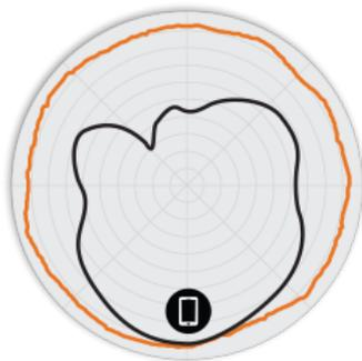
Abbildung 3. R710 5 GHz-Azimet-Antennenmuster
