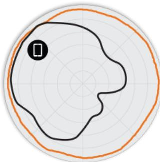
Abbildung 4. R710 2,4 GHz-Elevation-Antennenmuster
