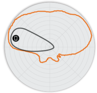
РИСУНОК 5 Вертикальная плоскость 5 ГГц R610 Диаграммы направленности антенны
