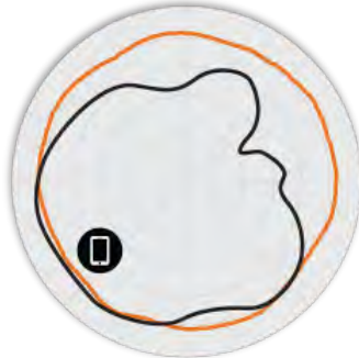
Figura 3. Padrões de antena do azimute R610 5 GHz
