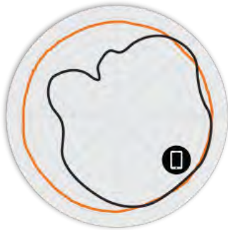
Figura 2. Padrões de antena do azimute R610 2,4 GHz
