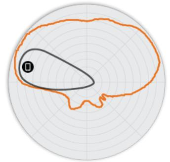
참고: 외부 트레이스는 모든 가능한 BeamFlex+ 안테나 패턴의 복합 RF 풋프린트를 나타내며 내부 트레이스는 복합 외부 트레이스 내의 BeamFlex+ 안테나 패턴을 나타냅니다.
