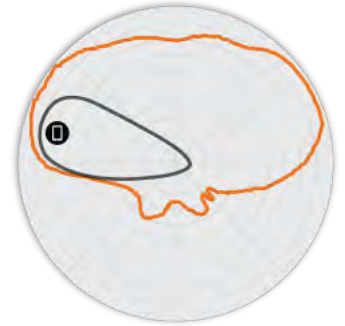
図 5. R610 5GHz エレベーション アンテナ パターン
