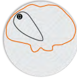
図 4. R610 2.4GHz エレベーション アンテナ パターン
