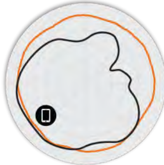
図 3. R610 5GHz アジマス アンテナ パターン
