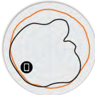
Figure 3. R610 5 GHz: patrones de antena en acimut
