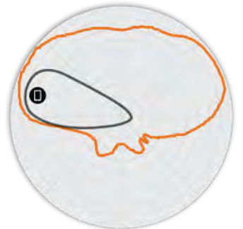
Figure 5. R610 5 GHz: patrones de antena en elevación
