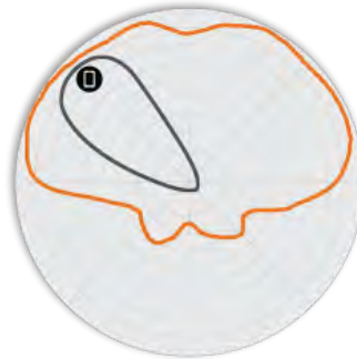
Figure 4. R610 2,4 GHz: patrones de antena en elevación
