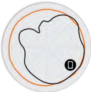
Figure 2. R610 2,4 GHz: patrones de antena en acimut
