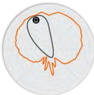
Рисунок 5. Вертикальная плоскость 5 ГГц R510 Диаграммы направленности антенны
