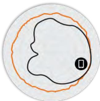
Рисунок 4. Вертикальная плоскость 2,4 ГГц R510 Диаграммы направленности антенны
