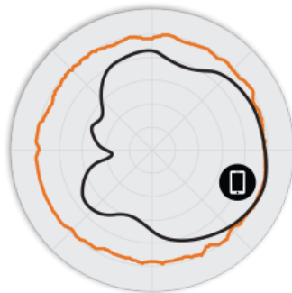
РИСУНОК 3 Азимутальная плоскость 5 ГГц R510 Диаграммы направленности антенны
