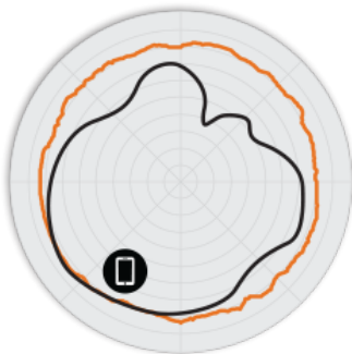
РИСУНОК 2 Азимутальная плоскость 2,4 ГГц R510 Диаграммы направленности антенны
