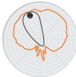
РИСУНОК 4 Вертикальная плоскость 2,4 ГГц R510 Диаграммы направленности антенны
