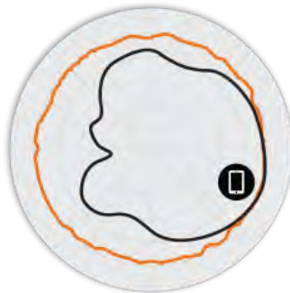
図 3. R510 5GHz アジマス アンテナ パターン
