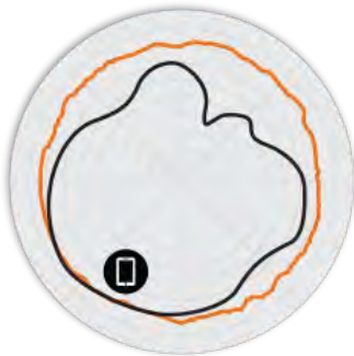
図 2. R510 2.4GHz アジマス アンテナ パターン
