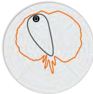
図 4. R510 2.4GHz エレベーション アンテナ パターン
