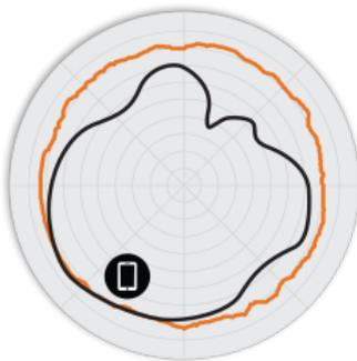
Figura 3. Pattern di antenna Azimut a 5 GHz per R510
