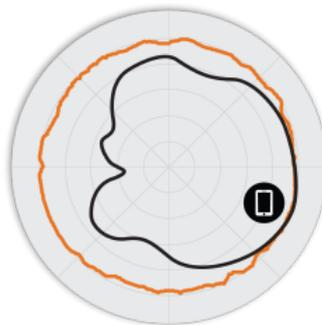
Figura 4. Pattern di antenna Elevazione a 2,4 GHz per R510
