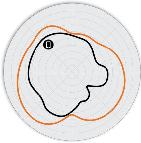
Figura 2. R350 2,4 GHz: patrones de antena en acimut
