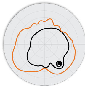
Figura 3. R350 5 GHz: patrones de antena en acimut
