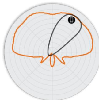
注意：外侧轨迹表示所有可能 BeamFlex 天线模式的复合射频足迹，而内侧轨迹则表示复合外侧轨迹中的一个 BeamFlex 天线模式。
