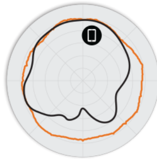
그림 3 R320 5GHz 방위각 안테나 패턴
