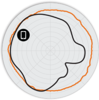
그림 2 R320 2.4GHz 방위각 안테나 패턴
