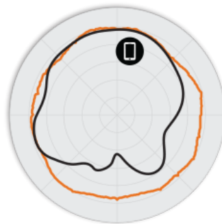
Figure 3. Diagrammes d'antennes Azimut R320 5 GHz
