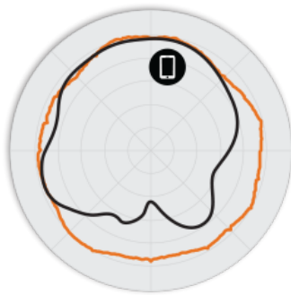
圖 3 R310 5GHz 方位角天線模式
