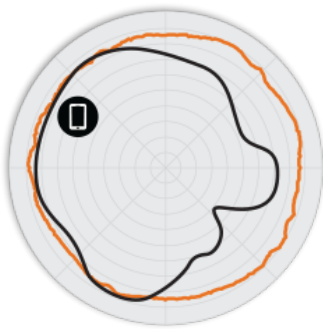
圖 2 R310 2.4GHz 方位角天線模式
