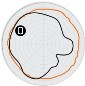
Figura 2. Padrões de antena do azimute R310 2,4 GHz
