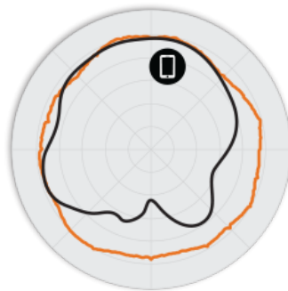
Figura 3. Padrões de antena do azimute R310 5 GHz
