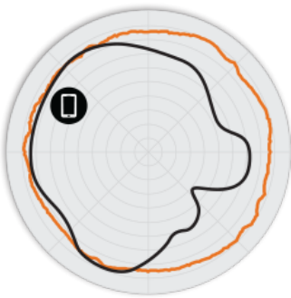
그림 2 R310 2.4GHz 방위각 안테나 패턴
