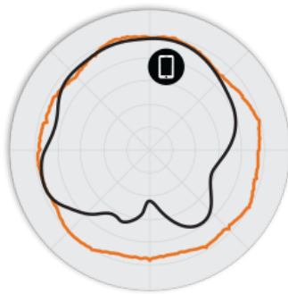
그림 3 R310 5GHz 방위각 안테나 패턴
