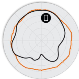
図 3. R310 5GHz アジマス アンテナ パターン
