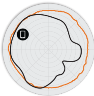
Figura 2. Pattern di antenna Azimut a 2,4 GHz per R310
