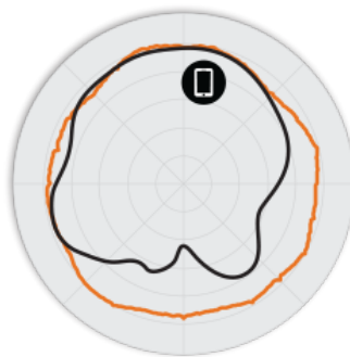
Figura 3. Pattern di antenna Azimut a 5 GHz per R310
