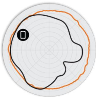
Figure 3. Diagrammes d'antennes Azimut R310 5 GHz
