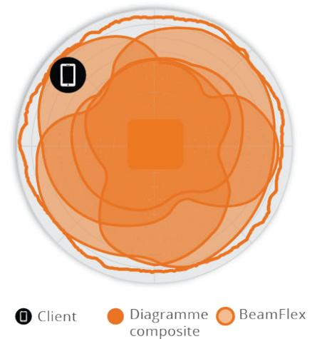
Figure 2. Diagrammes d'antennes Azimut R310 2,4 GHz
