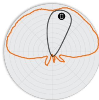
Figure 5. Diagrammes d'antennes Élévation R310 5 GHz
