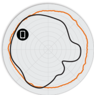
Figure 2. R310 2,4 GHz: patrones de antena en acimut
