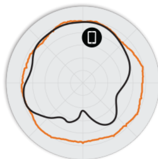
Figure 3. R310 5 GHz: patrones de antena en acimut
