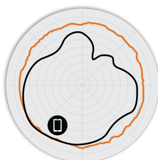
圖 2 M510 2.4GHz 方位角天線模式
