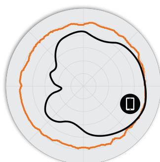
圖 3 M510 5GHz 方位角天線模式
