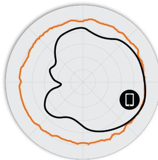
FIGURA 4 Padrões de antena de elevação M510 2,4 GHz
