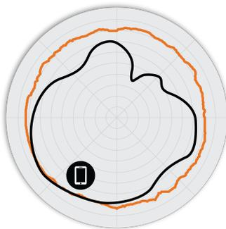
FIGURA 3 Padrões de antena do azimute M510 5 GHz
