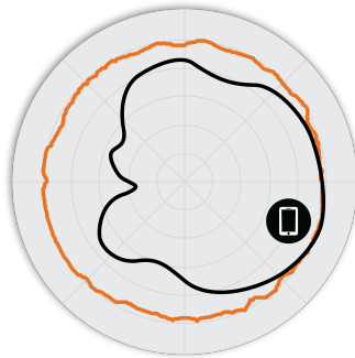
그림 3 M510 5GHz 방위각 안테나 패턴
