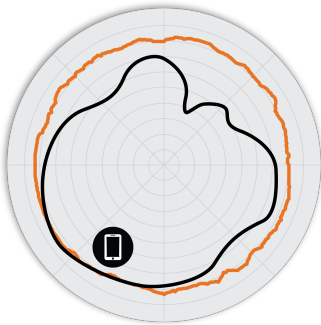
그림 2 M510 2.4GHz 방위각 안테나 패턴
