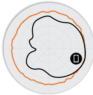
図 3 M510 5GHz アジマス アンテナパターン
