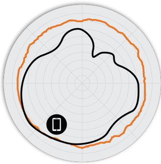
図 2 M510 2.4GHz アジマス アンテナパターン
