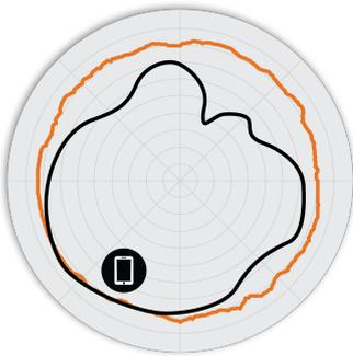
FIGURE 3 Diagrammes d'antennes Azimut M510 5 GHz
