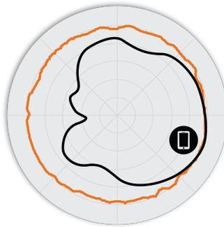
FIGURE 4 Diagrammes d'antennes Élévation M510 2,4 GHz
