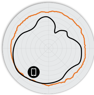
FIGURA 2 M510 2,4 GHz: patrones de antena en acimut
