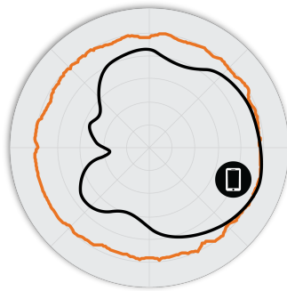
FIGURA 3 M510 5 GHz: patrones de antena en acimut
