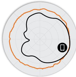
Abbildung 4. M510 2,4 GHz-Elevation-Antennenmuster
