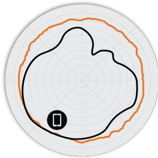
Abbildung 3. M510 5 GHz-Azimet-Antennenmuster
