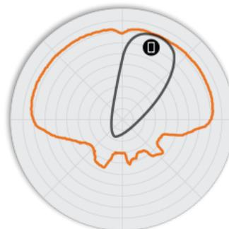
図 5. H510 5GHz エレベーション アンテナ パターン
