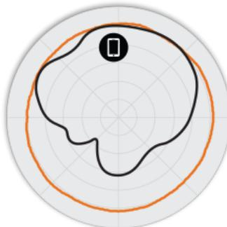
図 4. H510 2.4GHz エレベーション アンテナ パターン
