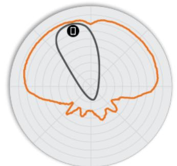
メモ: 外側のトレースは、可能なすべての BeamFlex+ アンテナ パターンの合成 RF フットプリントを表します。内側のトレースは、外側の複合トレース内の BeamFlex+ アンテナ パターンを表します。
