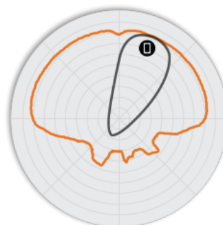
Figure 4. H510 2,4 GHz: patrones de antena en elevación
