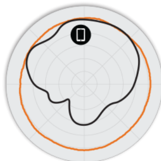
Figure 3. H510 5GHz: patrones de antena en acimut
