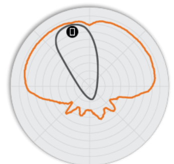
Figure 5. H510 5GHz: patrones de antena en elevación
