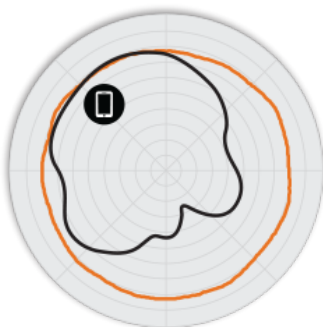
Figure 2. H510 2,4 GHz: patrones de antena en acimut
