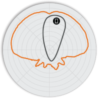
Рисунок 5. Вертикальная плоскость 5 ГГц H320 Диаграммы направленности антенны
