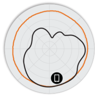
Figura 3. Padrões de antena do azimuth H320 5 GHz
