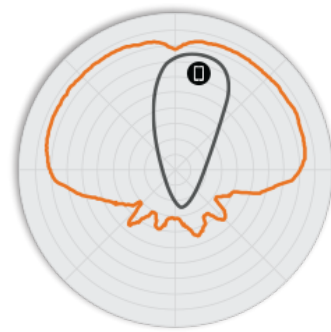
Figura 5. Padrões de antena de elevação H320 5 GHz
