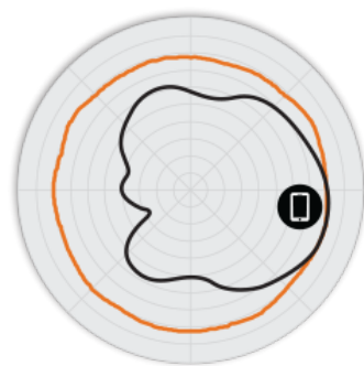
Figura 2. Padrões de antena do azimuth H320 2,4 GHz
