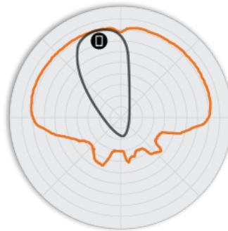
그림 4 H320 2.4GHz 고도 안테나 패턴
