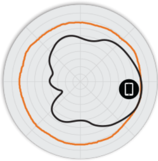
그림 2 H320 2.4GHz 방위각 안테나 패턴
