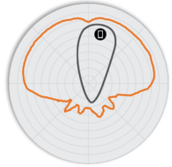
그림 5 H320 5GHz 고도 안테나 패턴
