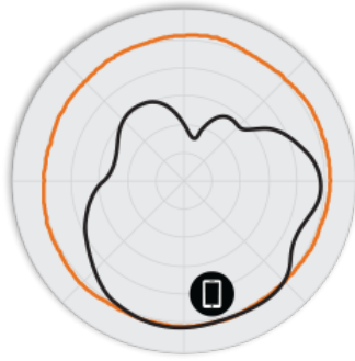
그림 3 H320 5GHz 방위각 안테나 패턴
