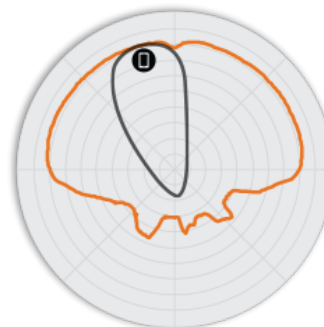
図 4. H320 2.4GHz エレベーション アンテナ パターン
