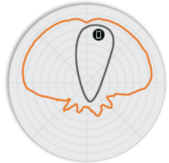
図 5. H320 5GHz エレベーション アンテナ パターン
