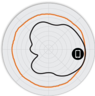
図 2. H320 2.4GHz アジマス アンテナ パターン
